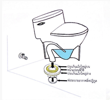
ภาพ แสดงตัวอย่างการติดตั้งประกันป้องกันการรั่วของกลิ่นจากท่อรับสิ่งปฏิกูล
